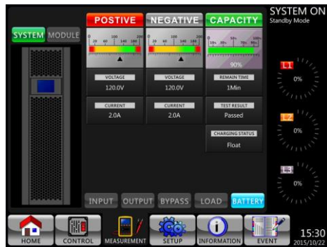
Figura 4-9 Pantallas de medición del sistema Toque el icono MODULE para monitorear el valor de medición del módulo.
