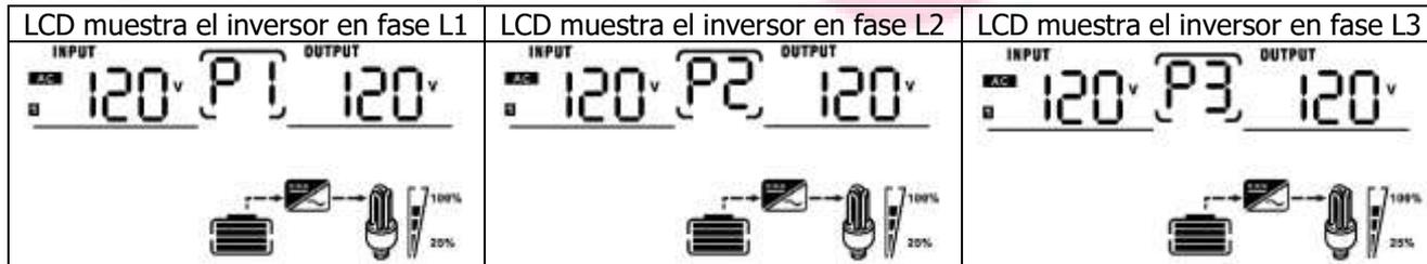
Paso 4: Encienda todos los interruptores de CA de cables de línea en la entrada de CA. Si se detecta la conexión de CA y se emparejan tres fases con la configuración de la unidad, funcionarán normalmente. En sentido contrario, mostraría el icono de CA intermitente y no funcionarán en modo de línea. Bajo esta
