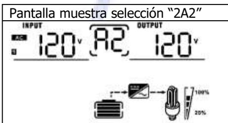
Paso 4: Encienda todos los interruptores de CA de cables de línea en la entrada de CA. Es mejor conectar todos los inversores a la utilidad al mismo tiempo. Si no es así, mostrará el error 82 en los siguientes inversores. Sin embargo, estos inversores se reiniciarán automáticamente. Si detectan la conexión de CA, funcionarán normalmente.
