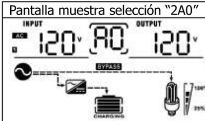
Paso 5: Si no hay más alarma de fallos, el sistema paralelo está completamente instalado.
