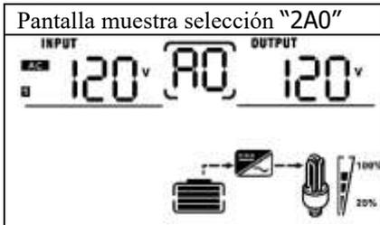
Paso 4: Encienda todos los interruptores de CA de los cables de línea en la entrada de CA. Es mejor conectar todos los inversores a la utilidad al mismo tiempo. Si no es así, mostrará el error 82 en los siguientes inversores. Sin embargo, estos inversores se reiniciarán automáticamente. Si detectan la conexión de CA, funcionarán normalmente.
